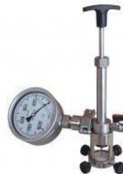
10711 c აფომეტრი პერმანენტული უნივერსალური (გვირგ. საცობი, PET თავსახური, ბოთლში შიდა წნევის გასაზომად - 860 ლარი
