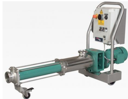
ექსცენტრულშნეკიანი (მონო) ტუმბო ღვინისა და დურდისთვის, ელექტროპანელით, სიჩქარის ვარიატორით. მოდ. MPL 31 (DIN50) 1-4 ტ/სთ 24 188 ლარი
